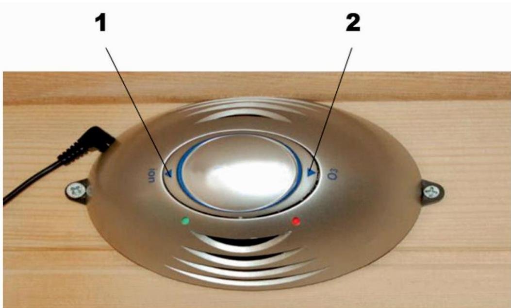
1. zapnutí/vypnutí ionizátoru (při zapnutí svítí zelená kontrolka)
